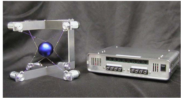
図1 力覚提示装置SPIDAR
