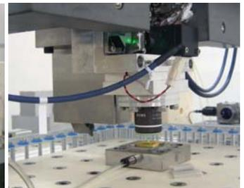
オンマシン形状計測システムによる形状計測の様子
