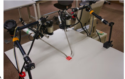
図2 力覚提示機能を有する 手術支援ロボットシステム
