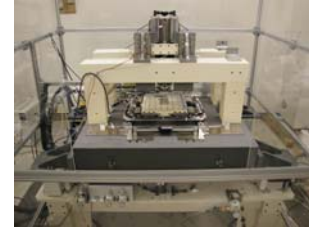
広域ナノパターンジェネレータ (ANGEL) Advanced nano-pattern generator with large work area
