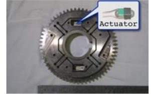
能動制振歯車装置（回転方向駆動機構）
