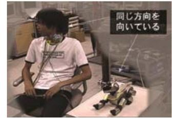
筋電信号を用いたインターフェース：筋肉の活動を示す筋電信号を計測し、仮想世界のロボットや自分の分身を動かすことができる。
