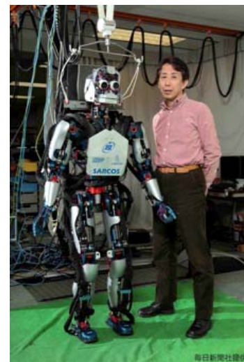
新規に開発した、51自由度を持つヒューノイドロボットCBi (Computational Brain -interface)
