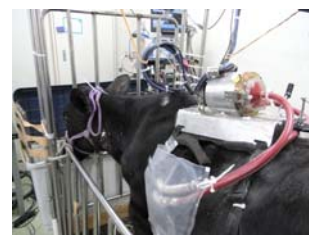
使い捨て磁気浮上遠心血液ポンプと動物実験 Disposable maglev centrifugal blood pump and animal test
