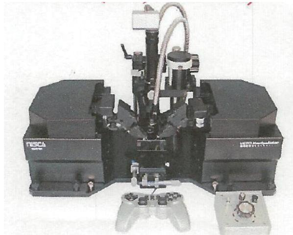
図1 微小物把持操作用マイクロマニピュレータ
