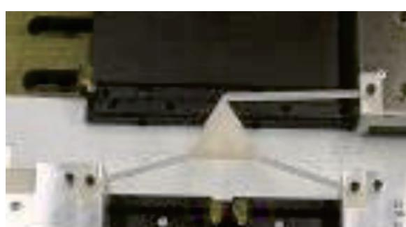
図5 特異点のないポリマー製3自由度位置・姿勢決めテーブル(2本のレール上の3アクチュエーターで駆動、ポリプロピレン製)
