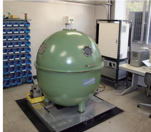
図1 加工環境制御超精密加工システム
