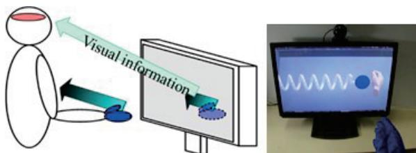
図3 視覚による疑似力覚を用いたユーザインターフェース
