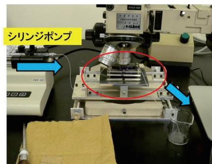
図3 DLD粒子分離実験概要図
